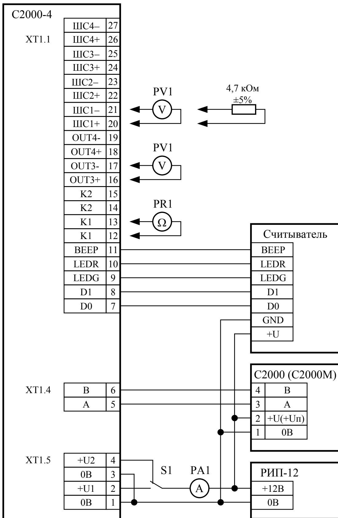
**PV1, PR1, PA1** – прибор комбинированный (тестер) в режиме измерения напряжения, сопротивления и тока соответственно
