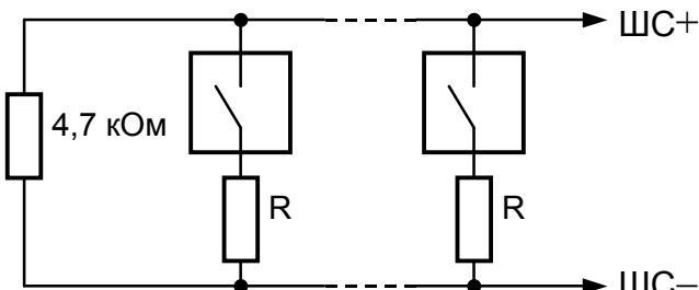
$R = 1,5 \text{ кОм} \pm 5\%$  для ДИП-ЗСУ, ДИП-У (напряжение на сработавшем извещателе от 7,5 до 8,5 В)
