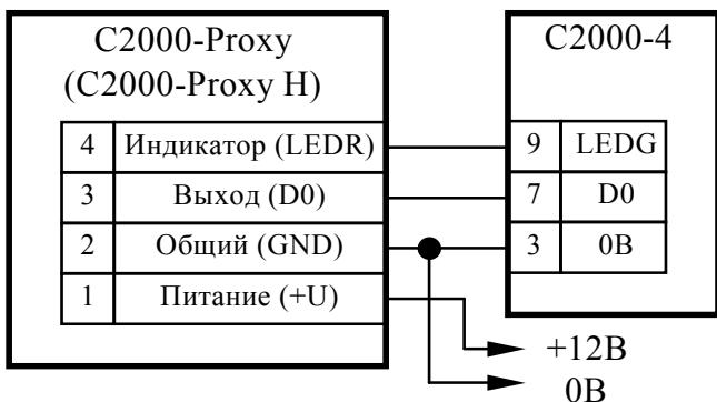
**Схема подключения C2000-Proxy и C2000-Proxy H**
