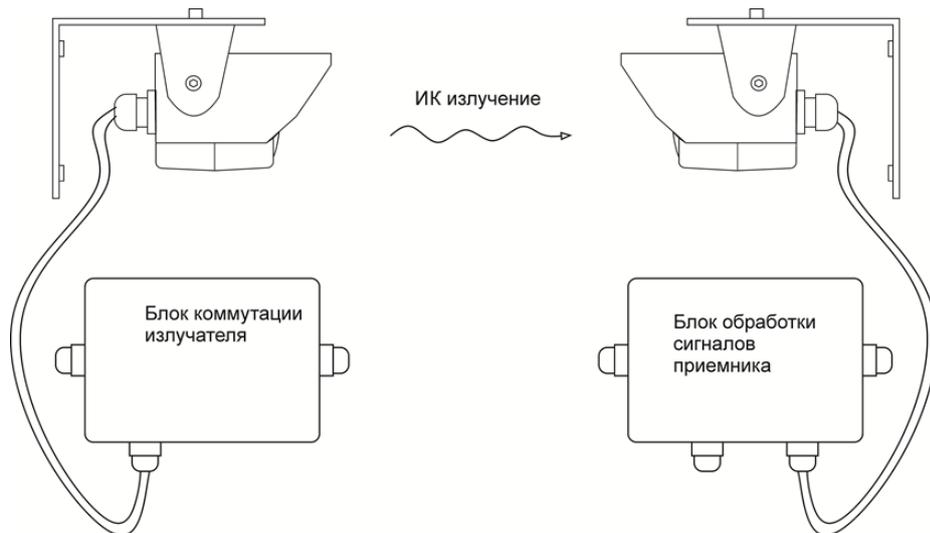
Рисунок 1 - Общий вид извещателя
