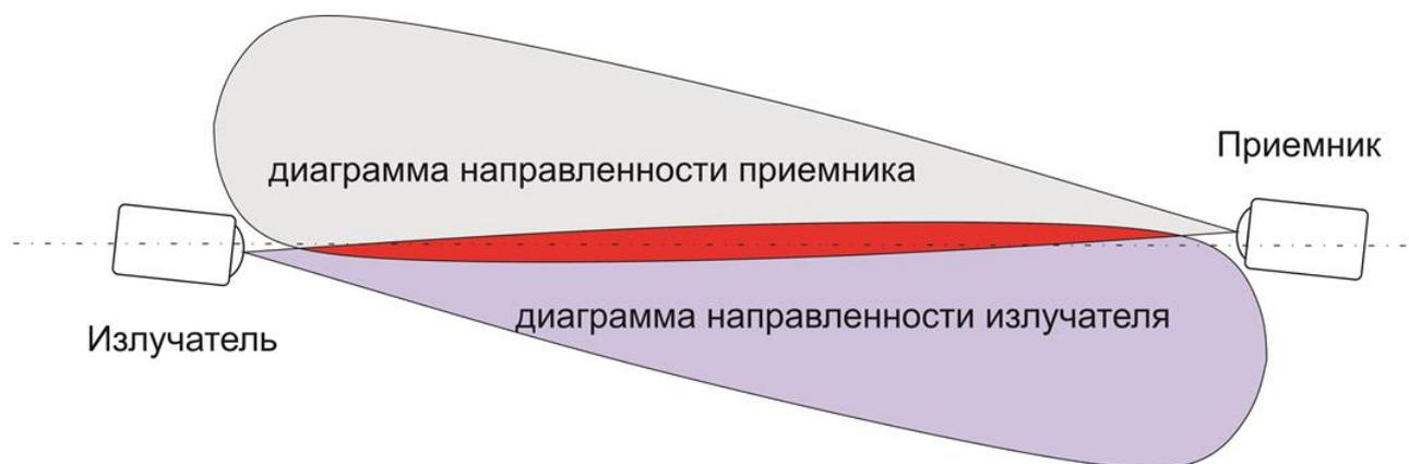
Рисунок 8 - Настройка приемника на край диаграммы направленности излучателя
