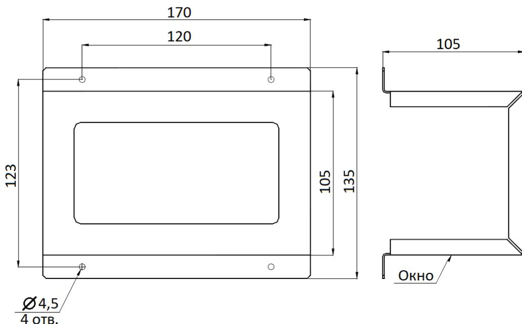
Рисунок 2 - Габаритные размеры защитного кожуха
