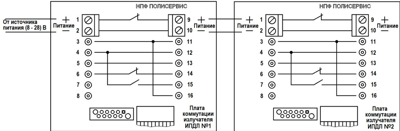
Рисунок 11 - Схема соединения плат коммутации излучателей между собой
