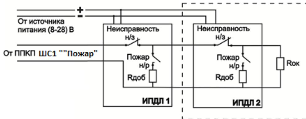
а) Схема подключения приемника к ППКП
