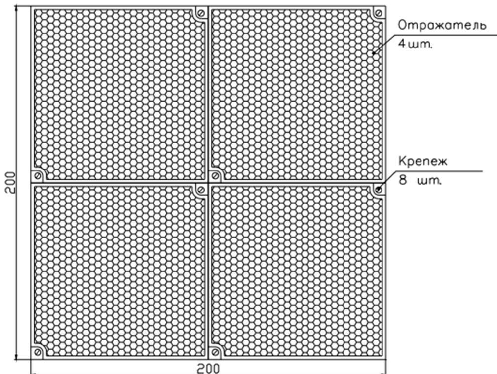
Рисунок 2 - Монтажный чертеж четырех отражателей
