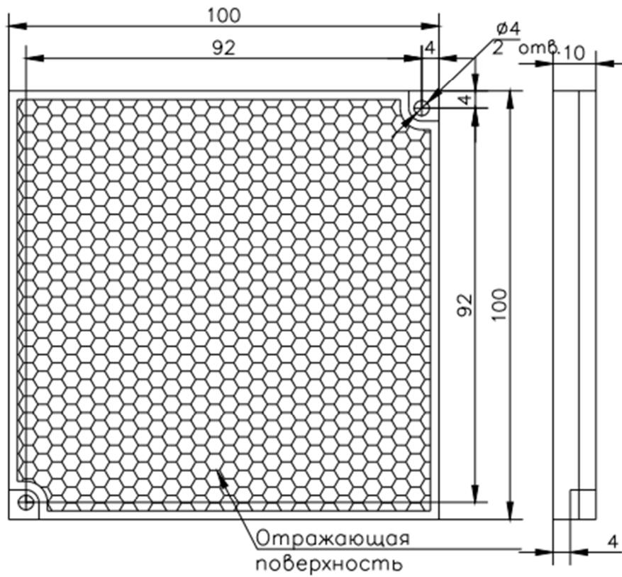
Рисунок 1 - Общий вид отражателя
