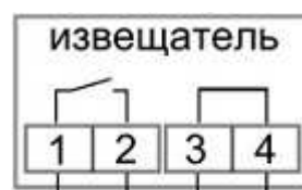
Рисунок 2в. Схема подключения ИО102-51(НР+Пр)
