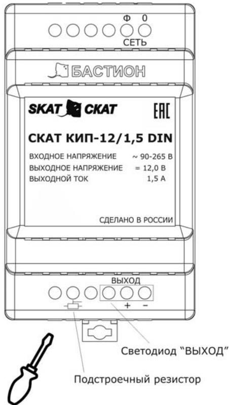
Изделие имеет в своём составе подстроечный резистор (рисунок 2), позволяющий при помощи отвёртки регулировать уровень выходного напряжения в пределах, указанных в таблице 1.
