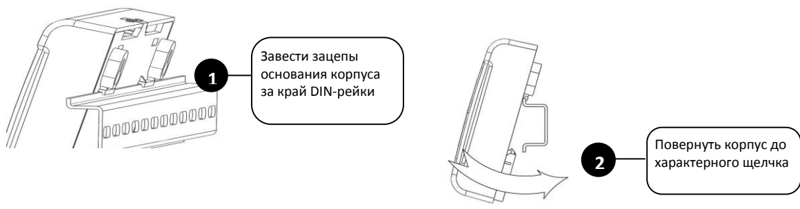
Рисунок 16 Монтаж устройства на DIN рейку
