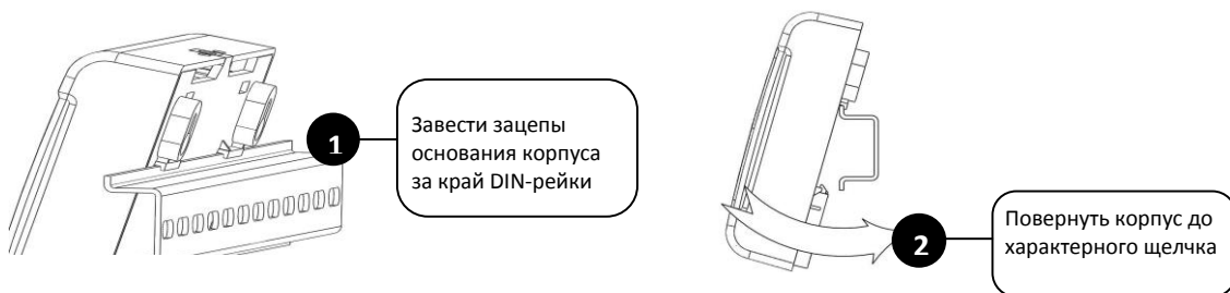
Рисунок 11 Монтаж ПОО УО-4С на DIN-рейку
