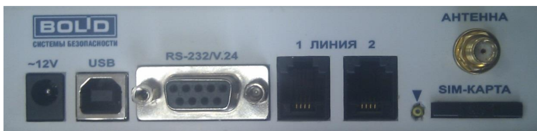
Рисунок 7 Задняя крышка «УОП-3 GSM» с разъёмами
