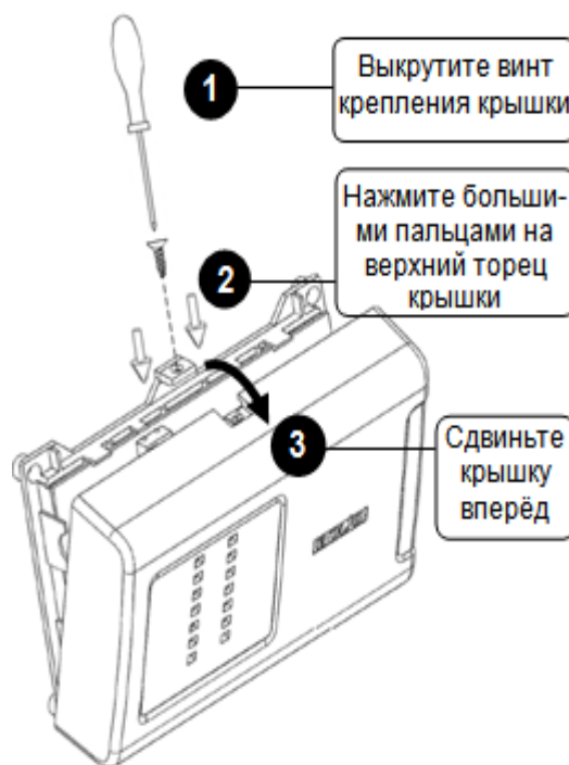
Рисунок 10 Снятие крышки УО-4С
