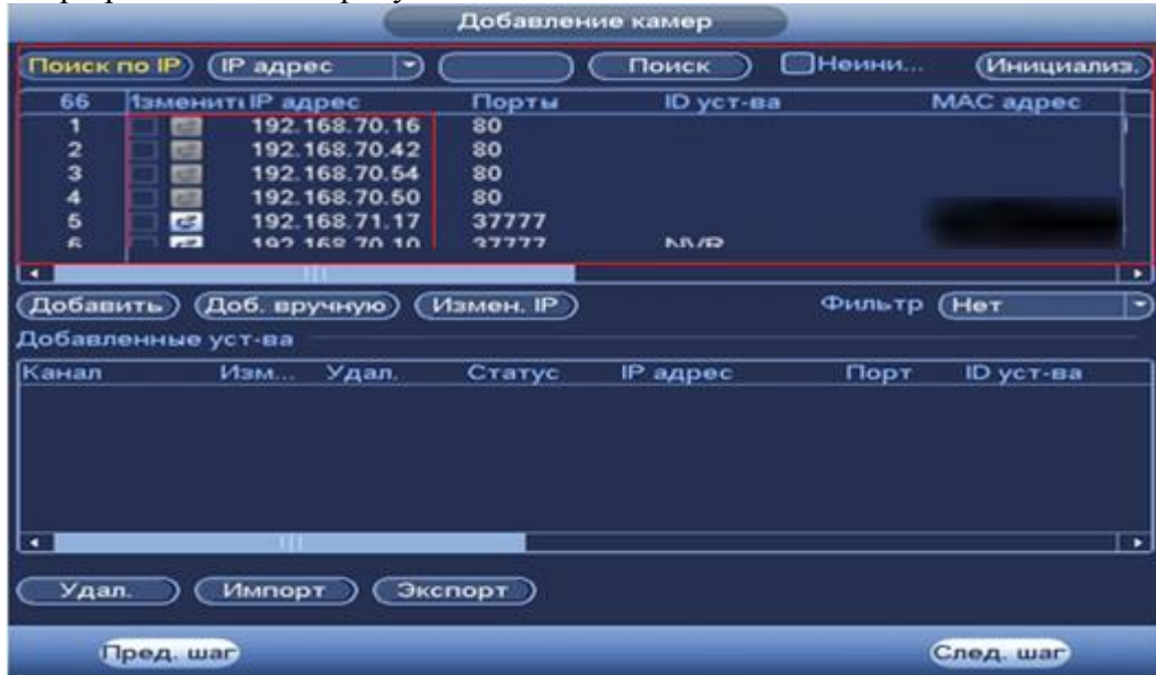
Рисунок 6.2.5.2 Настройка добавления камер по поиску в сети.
