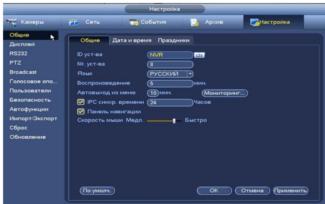
Рисунок 8.3.5.1.1.1 Интерфейс настройки общих параметров. Функции и диапазоны значений параметров даны в таблице 8.17:
