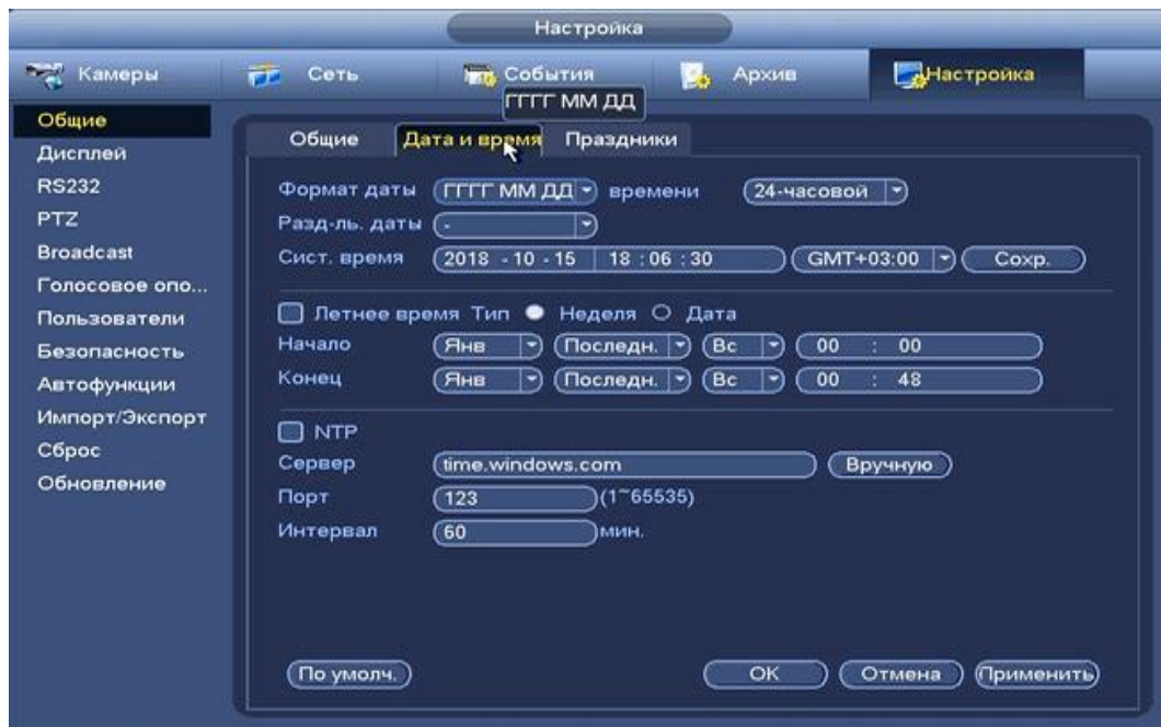
Рисунок 8.3.5.1.2.1 Интерфейс настройки даты и времени. Функции и диапазоны значений параметров даны в таблице 8.18.
