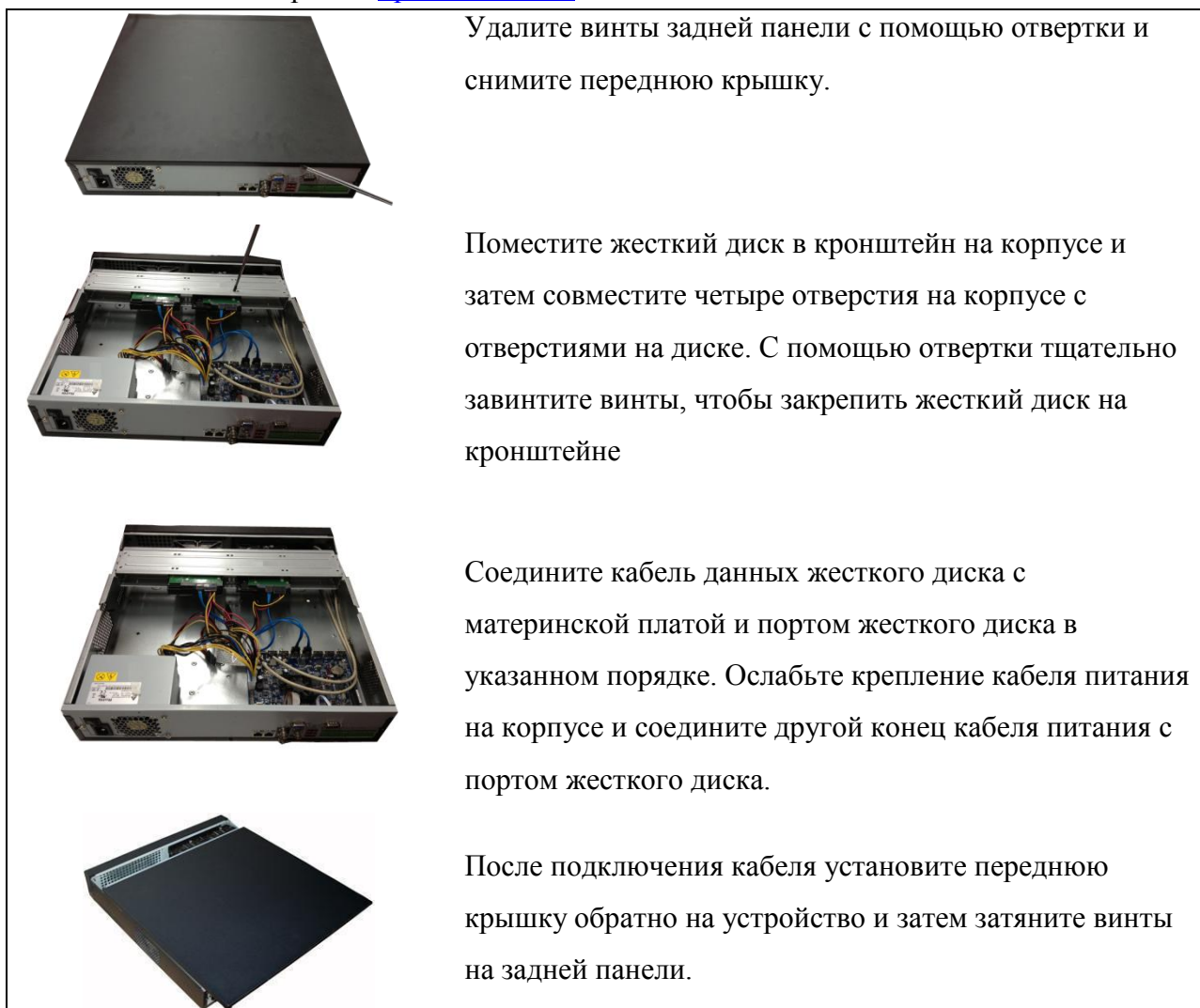
Рисунок 5.1-Установка жестких дисков
