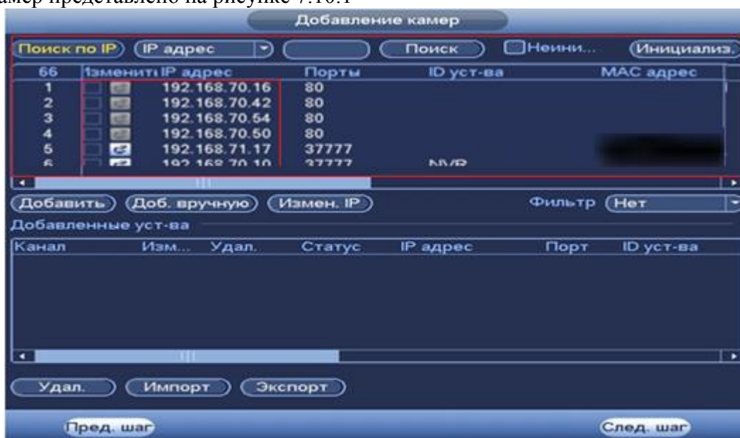
Рисунок 7.10.1 Настройка добавления камер по поиску в сети.
