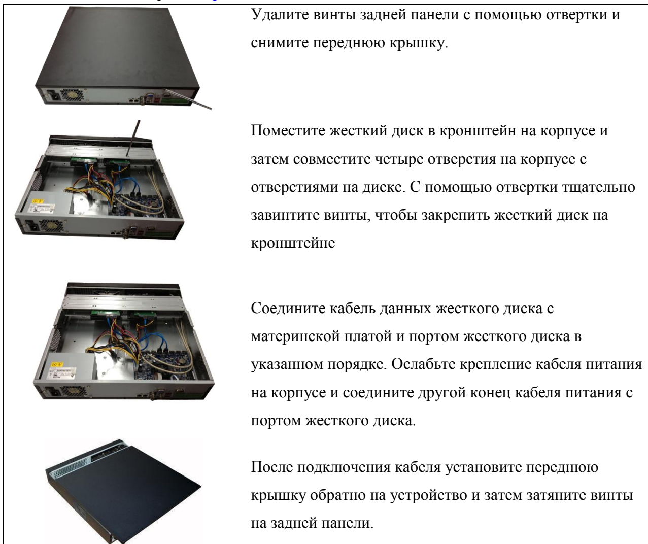
Рисунок 5.1-Установка жестких дисков
