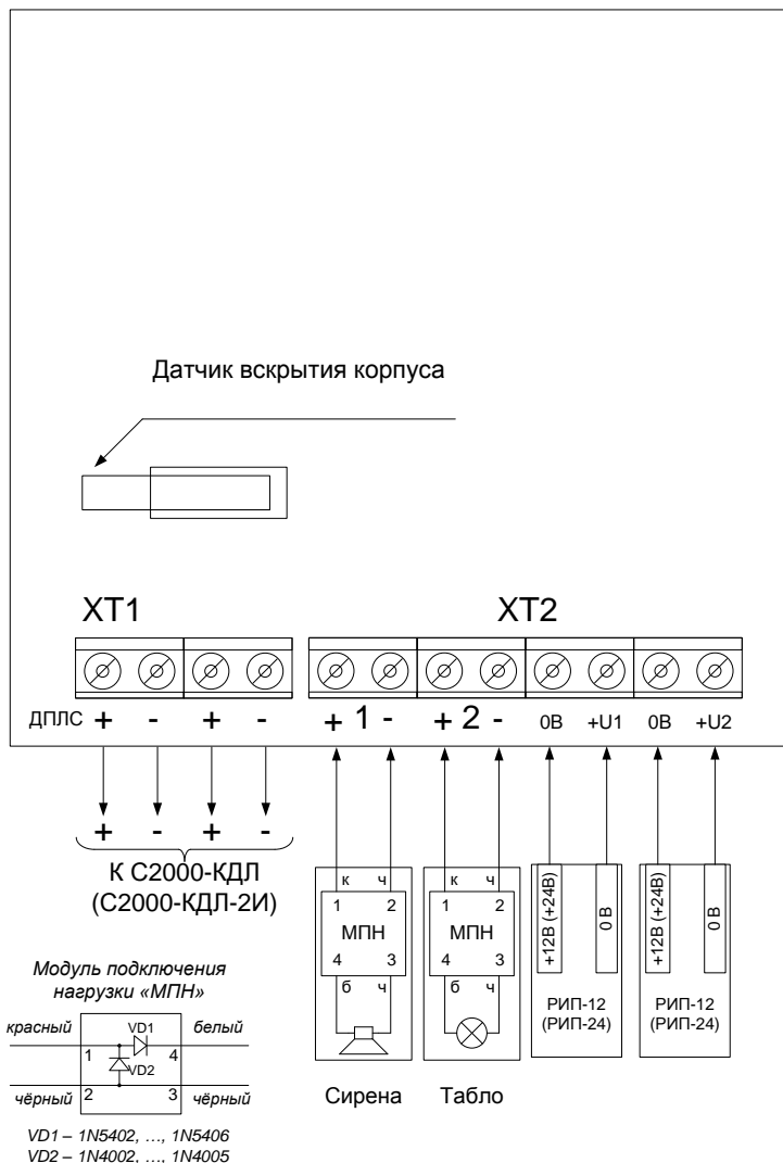
Рисунок 4. Схема внешних соединений блока
