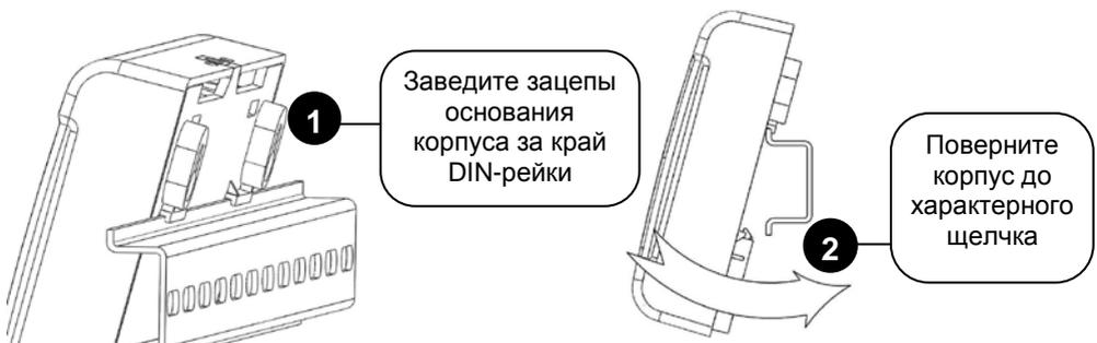
**Рисунок 3.** Монтаж блока на DIN-рейку
