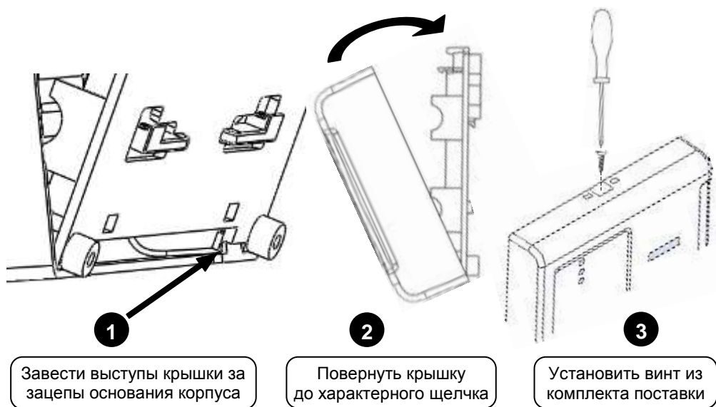
Рисунок 4. Установка крышки прибора
