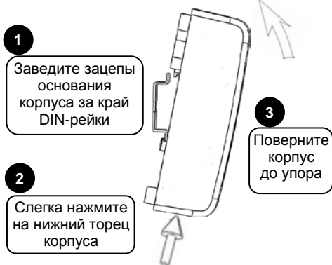
Рисунок 3. Крепление на DIN-рейку
