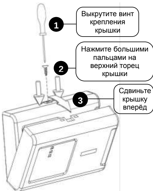
Рисунок 2. Снятие крышки блока
