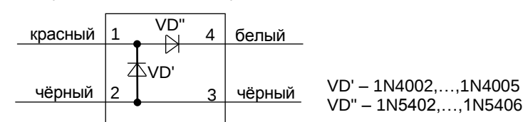
Рисунок 4. Схема внешних соединений блока
