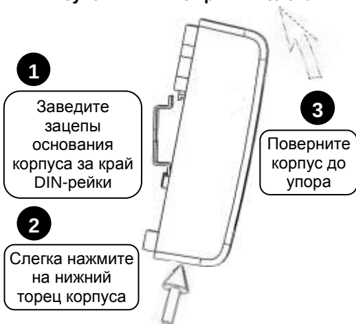
Рисунок 3. Крепление блока на DIN-рейку
