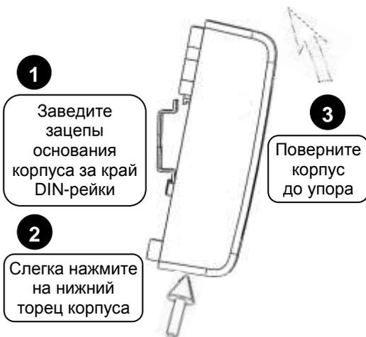
Рисунок 3. Крепление контроллера на DIN-рейку
