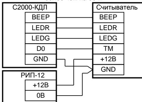
**Рисунок 6.** Схема подключения считывателей с интерфейсом Touch Memory
