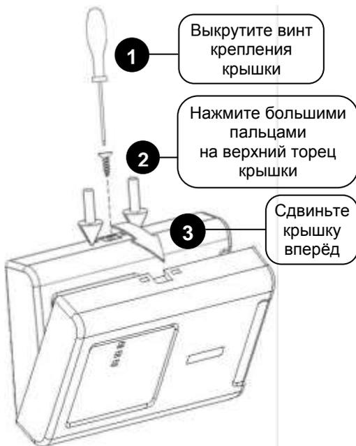
Рисунок 2. Снятие крышки контроллера
