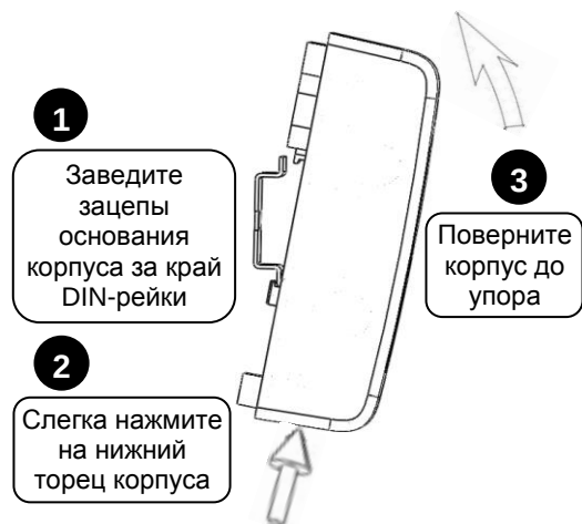
Рисунок 3. Крепление прибора на DIN-рейку
