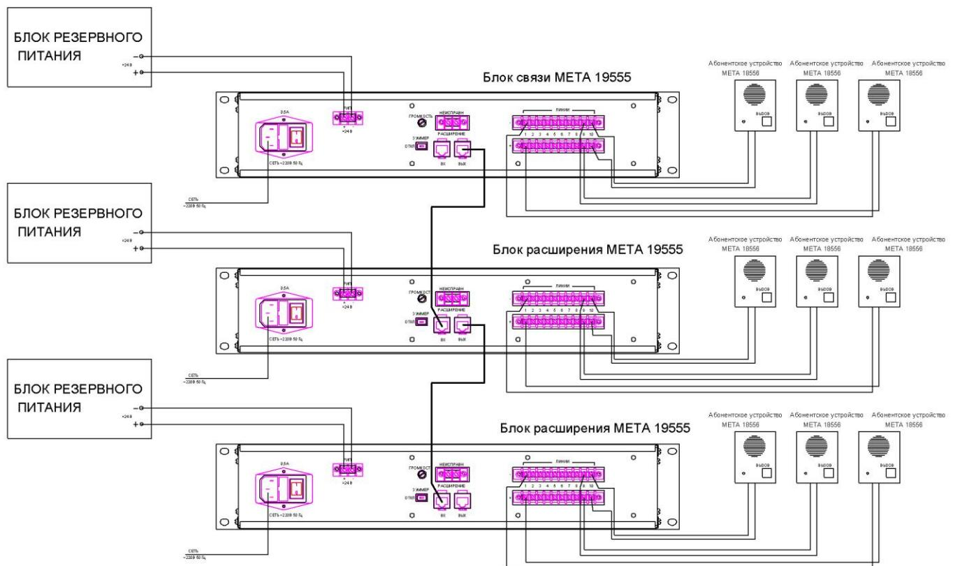
Блоки связи и расширения соединяются между собой кабелями с RJ разъемами, входящими в комплект блока расширения. Причем выход блока связи подключается ко входу блока расширения. Далее выход блока расширения подключается ко входу следующего блока расширения и т.д. Блоки БРП подключаются проводами сечением не менее 0,5 мм<sup>2</sup>.
