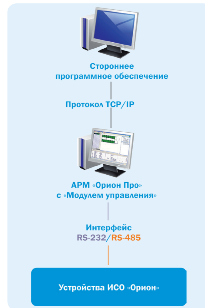
Рисунок 56. Интеграция с устройствами посредством интерфейса «Модуля управления» в АРМ «Орион Про»
