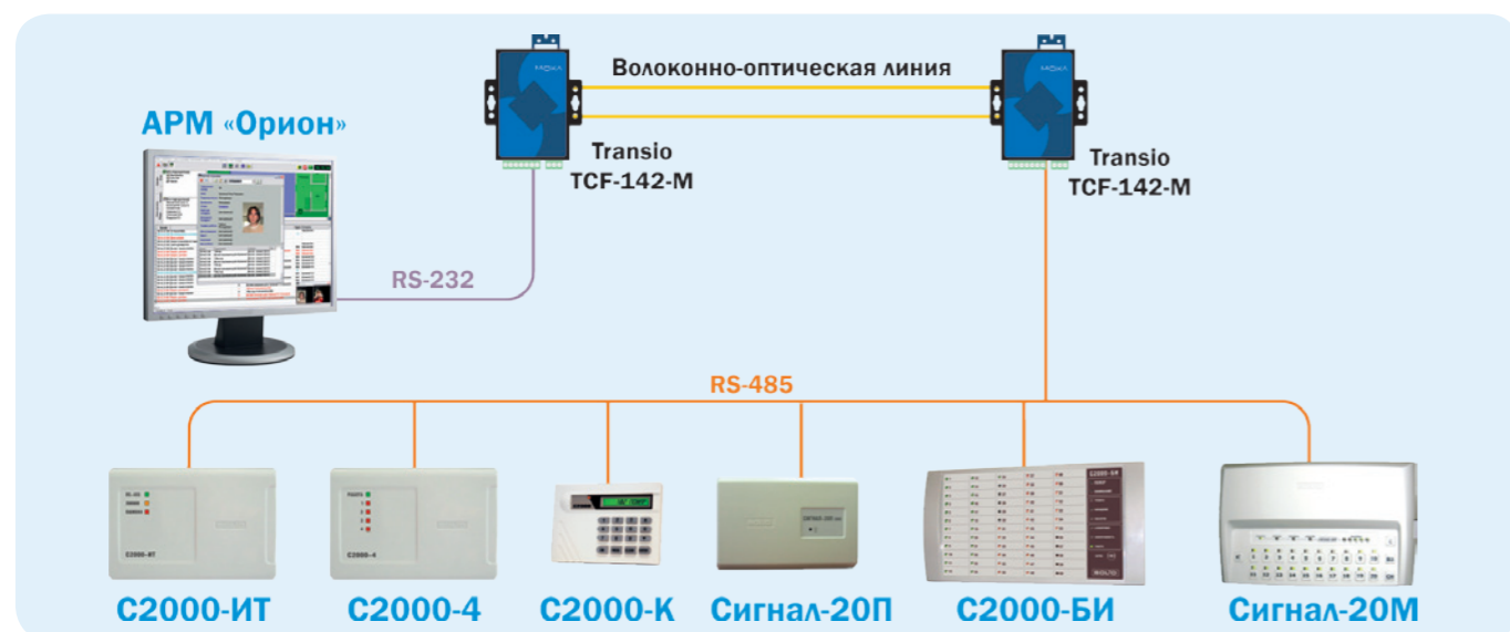
Рисунок 79. Типовая схема работы Transio TCF-142-M по протоколу «Орион»
