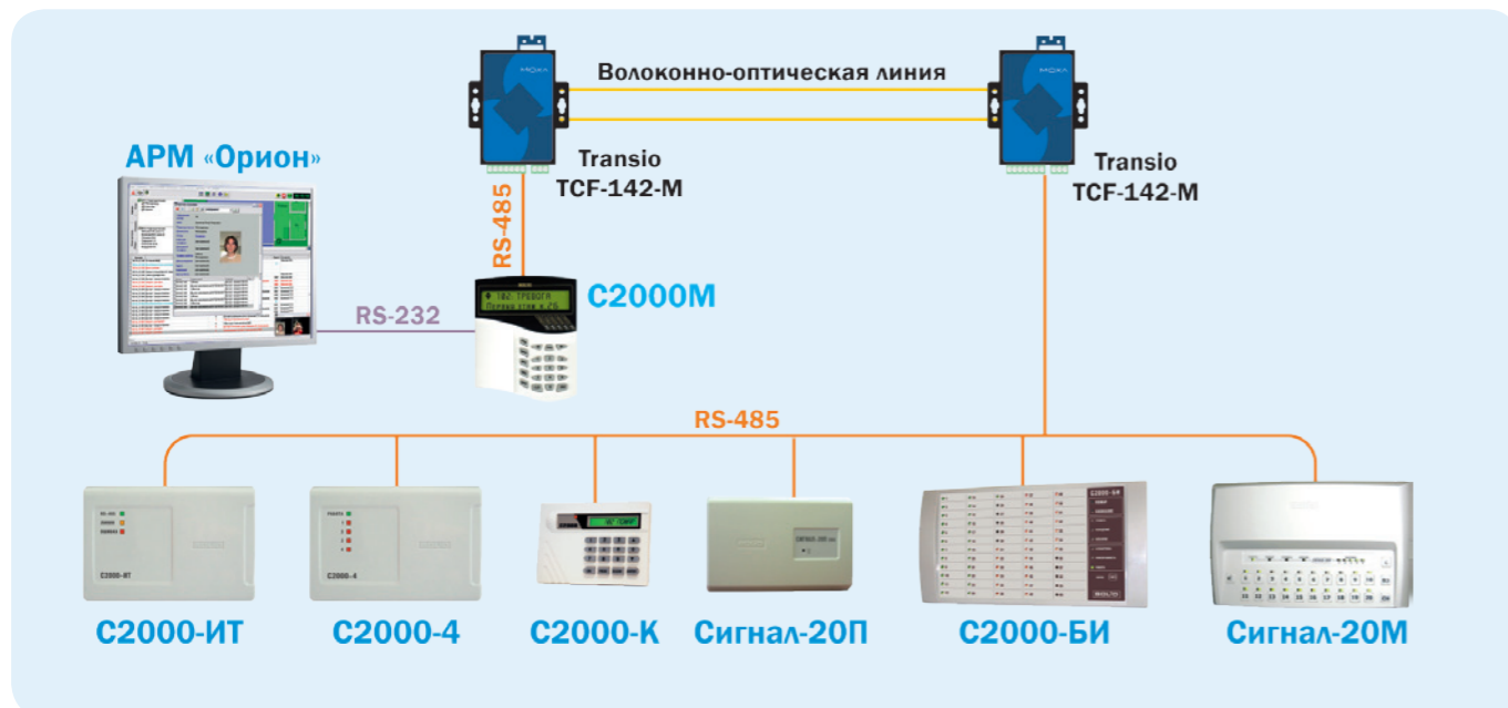
Рисунок 73. Структурная схема использования Transio TCF-142-M с АРМ «Орион» и «С2000М»
