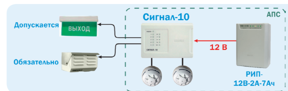
Рисунок 13. Пример СОУЭ 1-го типа на базе прибора «Сигнал-10»
